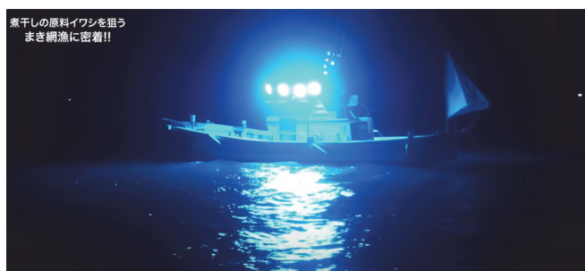
Рисунок 3 – Судно-подсветчик, оборудованное светодиодными люстрами
